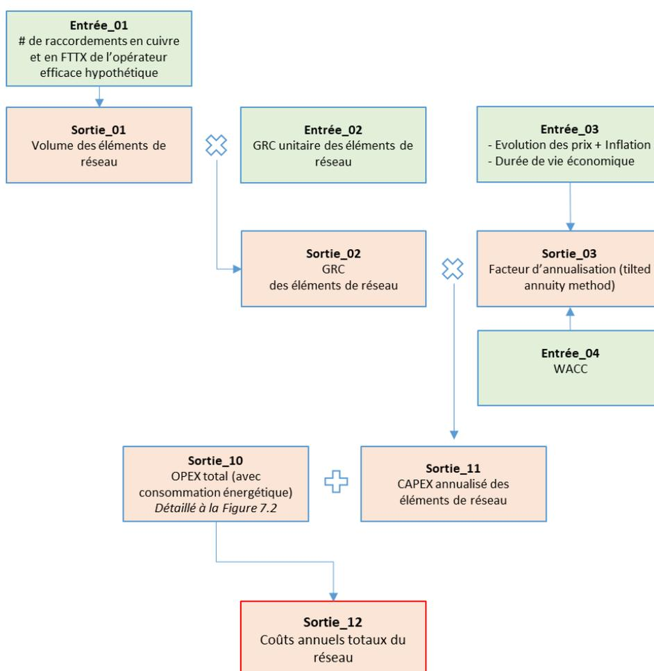
Figure 8-2 : Détermination des coûts d'exploitation du réseau
